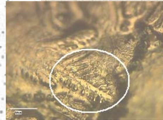
Dendrite d'étain vue sur la surface d'un joint
